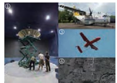
本研究で開発した円偏波合成開口レーダ(CP-SAR)搭載小型衛星・航空機・大型無人航空機(①~③)、2018年3月14日のCN235機の飛行実証実験により得られたCP-SARによる世界初の円偏波画像(④)
