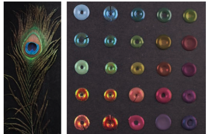
図1：（左図）孔雀の羽と、（右図）人工メラニン粒子を集積して作製した構造色ペレットの写真です。粒子の精密合成で、現在ディスプレイに使用されているほぼ全ての色の構造発色を実現しました。
